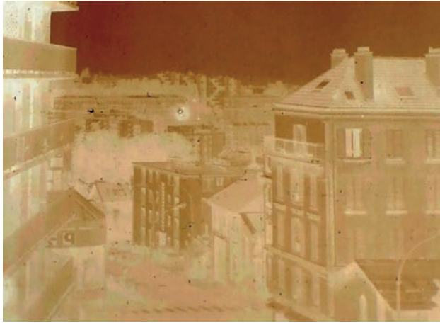
Photo 17 – Négatif au bitume de Judée sur argent obtenu en chambre obscure dans les mêmes conditions que Niépce avec un objectif d'ouverture f/4 . Temps de pose : 3 jours en plein soleil (J.-L. Marignier, 1991).
