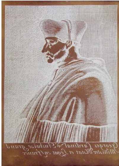
Photo 10 – Négatif au bitume de Judée sur étain du portrait du Cardinal d'Amboise (J.-L. Marignier, 1990).
