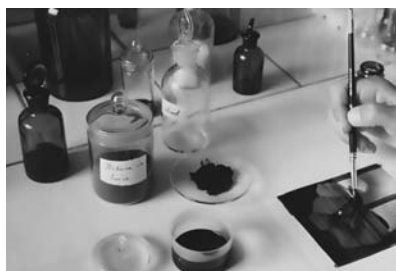
Photo 9 – Éléments nécessaires à la réalisation du vernis au bitume de Judée : poudre de bitume, solution concentrée dans de l'essence de lavande, étendage de la solution au pinceau sur une plaque de cuivre argenté.
