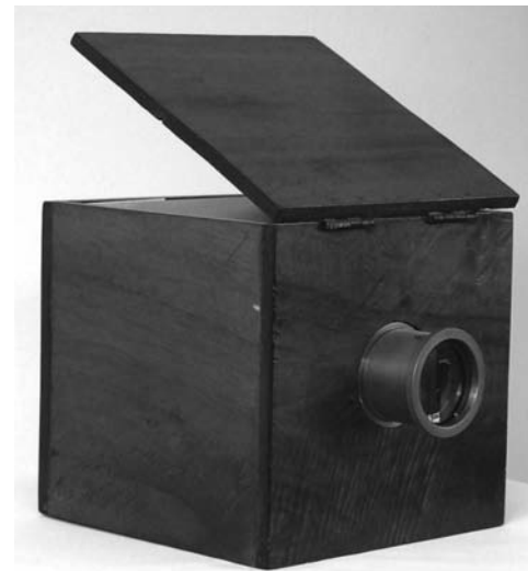
Photo 5 – Chambre obscure de 6 pouces de côté (16,2 cm) reconstituée en 1999, selon les indications de Niépce dans sa correspondance (Maison Niépce, Saint-Loup-de-Vareannes).
